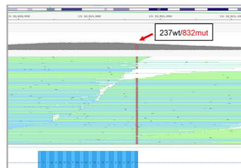
Рисунок 4. Однуклеотидная замена в сайте сплайсинга экзона 13 BRCA2 , частичная потеря гетерозиготности (LOH) в опухолевой ткани
